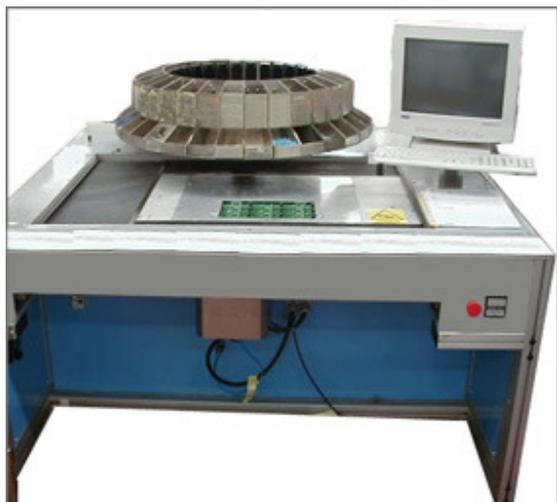
Tutti i parametri di lavoro della macchina sono gestiti da software su personal computer, e le caratteristiche di montaggio di ogni scheda sono salvabili in file, così da avere l'intero archivio all'interno della macchina. L'inserimento di una "Taglia e Piega" in una catena velocizza la produzione, diminuendo i tempi di montaggio dei componenti sulle schede. L'uso per l'operatore è molto semplice: la scheda
