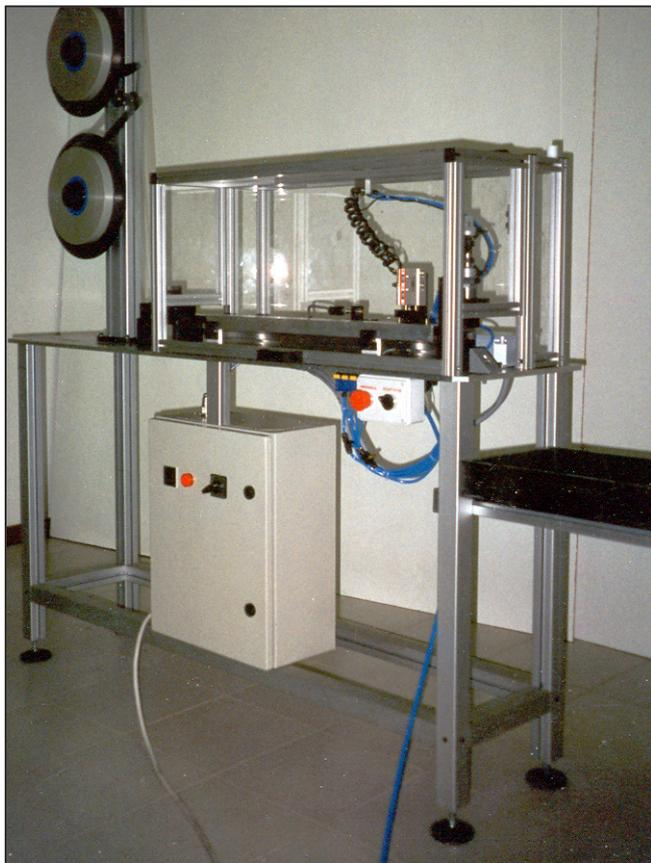
La misura del taglio è impostabile con semplicità a seconda della necessità e il numero dei pezzi è programmabile grazie ad un conteggio controllato dal programma in un plc.
