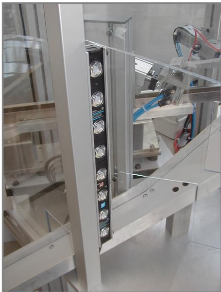
movimento se l'operatore si trova in un punto pericoloso della macchina. Un'operazione importante che l'attrezzatura esegue sui singoli pezzi è il collaudo e su ogni pezzo vengono eseguiti 2 tipi di collaudo: un primo collaudo di continuità (controllo valore resistenza elettrica) e un secondo collaudo di HP per verificare la giusta distanza tra avvolgimento elettrico e rivestimento metallico.
